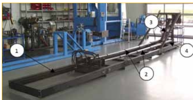
Rys. 3 Stanowisko pomiarowe: 1 – rama, 2 – siłowniki mechanizmu prasującego, 3 – siłownik ściany wypychającej, 4 – wózek
